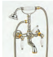
Art. 450 GRUPPO VASCA ESTERNO Deviatore automatico, duplex con flessibile mm. 1500, eccentrici da 1/2" regolabili per interasse da mm. 150 ± 15 EXTERNAL BATH MIXER Automatic diverter, duplex with shower hose mm. 1500, s-tailpieces with 1/2" connections, centre distance mm. 150 ± 15
