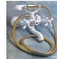
Art. 200 GRUPPO VASCA ESTERNO Deviatore automatico, duplex con flessibile mm. 1500, eccentrici da 1/2" regolabili per interasse da mm. 150 ± 15 EXTERNAL BATH MIXER Automatic diverter, duplex with shower hose mm. 1500, s-tailpieces with 1/2" connections, centre distance mm. 150 ± 15
