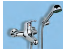
Art. 005 MISCELATORE MONOCOMANDO VASCA ESTERNO Deviatore automatico, duplex con flessibile mm.1500, eccentrici da 1/2" regolabili per interasse da mm. 150 ± 15 EXTERNAL SINGLE LEVER BATH MIXER Automatic diverter, duplex with shower hose mm. 1500, s-tailpieces with 1/2" connections, centre distance mm. 150 ± 15
