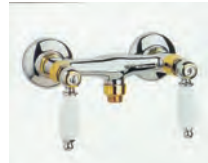
Art. 455 GRUPPO DOCCIA ESTERNO ATTACCO 1/2" Duplex con flessibile mm. 1500, eccentrici da 1/2" regolabili per interasse da mm. 150 ± 15 EXTERNAL SHOWER MIXER 1/2" COUPLING Duplex with shower hose mm. 1500, s-tailpieces with 1/2" connections, centre distance mm. 150 ± 15
