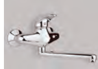
Art. 1033 MISCELATORE MONOCOMANDO LAVELLO A PARETE Bocca di erogazione girevole mm. 200 o 300, eccentrici da 1/2" regolabili per interasse da mm. 150 ± 15 WALL MOUNTED SINGLE LEVER SINK MIXER Swivel spout mm. 200 or 300, s-tailpieces with 1/2" connections, centre distance mm 150 ± 15
