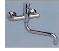
Art. 933 MISCELATORE MONOCOMANDO LAVELLO A PARETE Bocca di erogazione girevole mm. 200 o 300, eccentrici da 1/2" regolabili per interasse da mm.150 ± 15 WALL MOUNTED SINGLE LEVER SINK MIXER Swivel spout mm. 200 or 300, s-tailpieces with 1/2" connections, centre distance mm 150 ± 15
